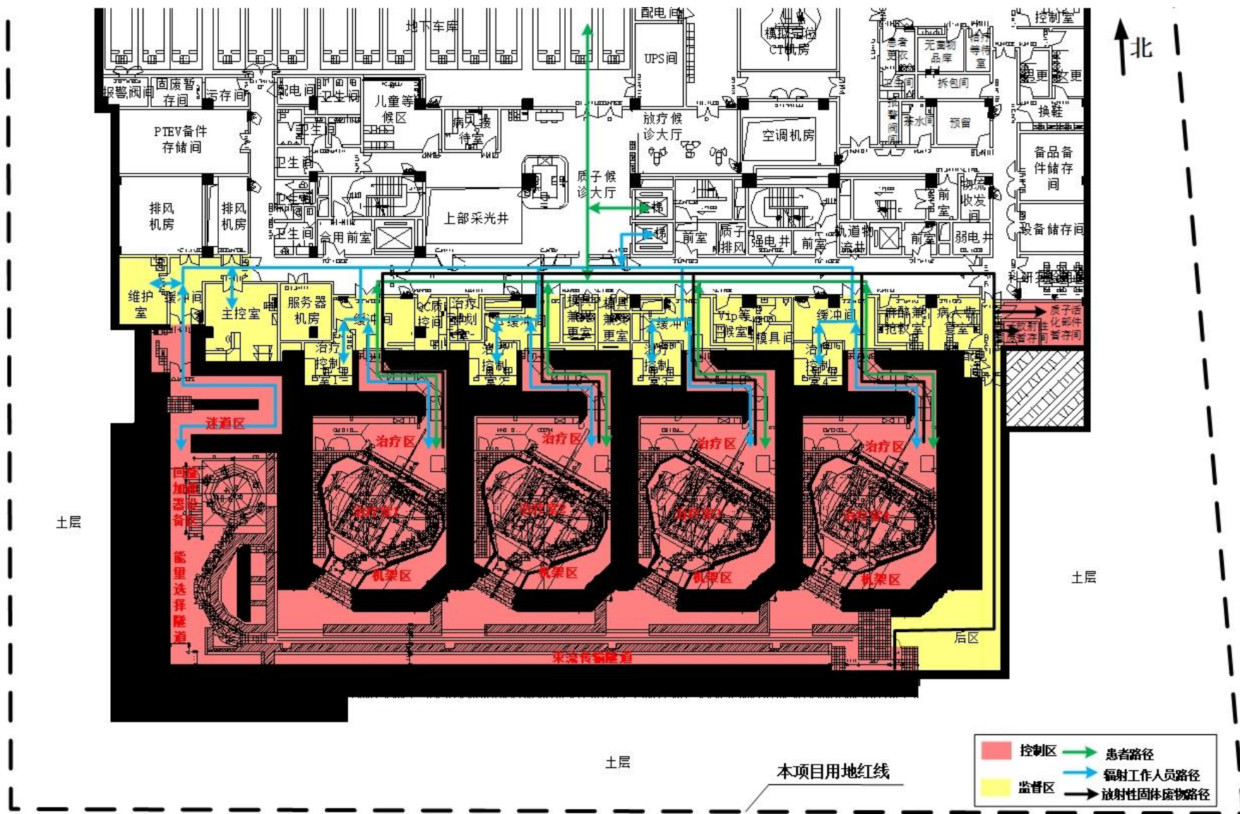
图 4.1.1.1-2 质子放射治疗系统负二层辐射工作场所分区及路径规划图
