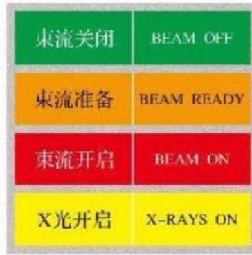
图 4.1.2.1-7 治疗室束流（工作）状态指示灯示意图
