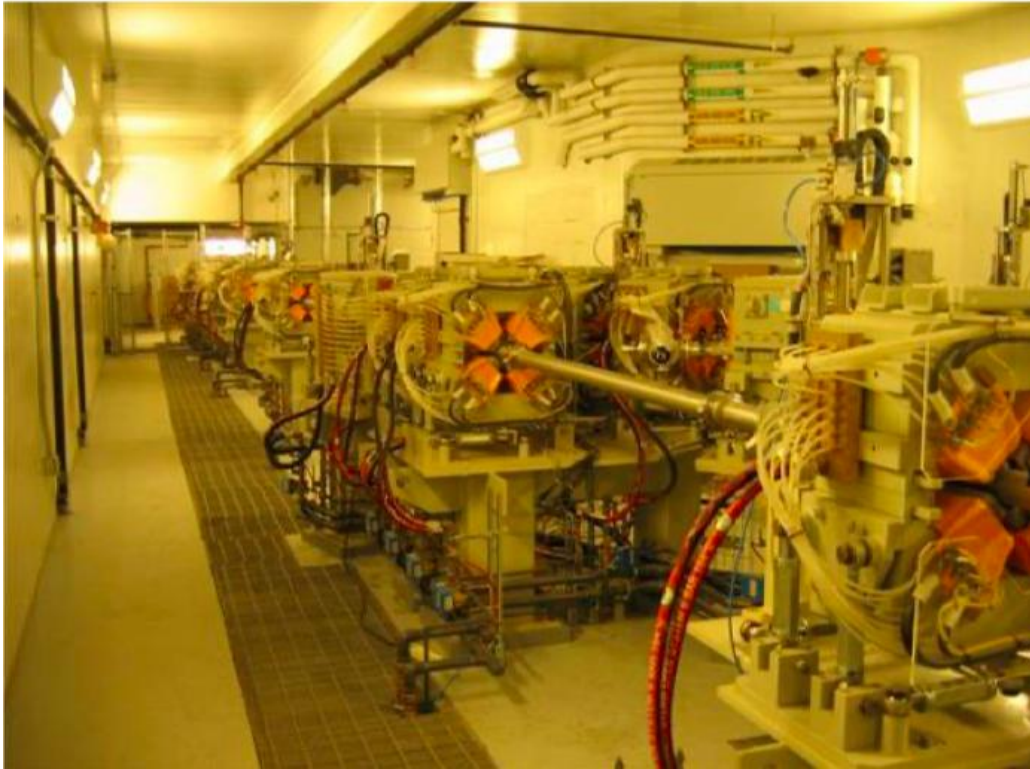
图 3.2.1.2-5 质子放射治疗系统束流运输系统实物参考图
