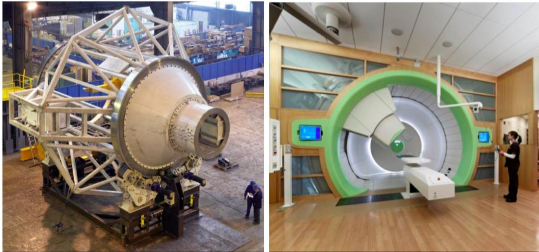
图 3.2.1.2-6 质子放射治疗系统旋转机架和机架治疗室实物参考图
