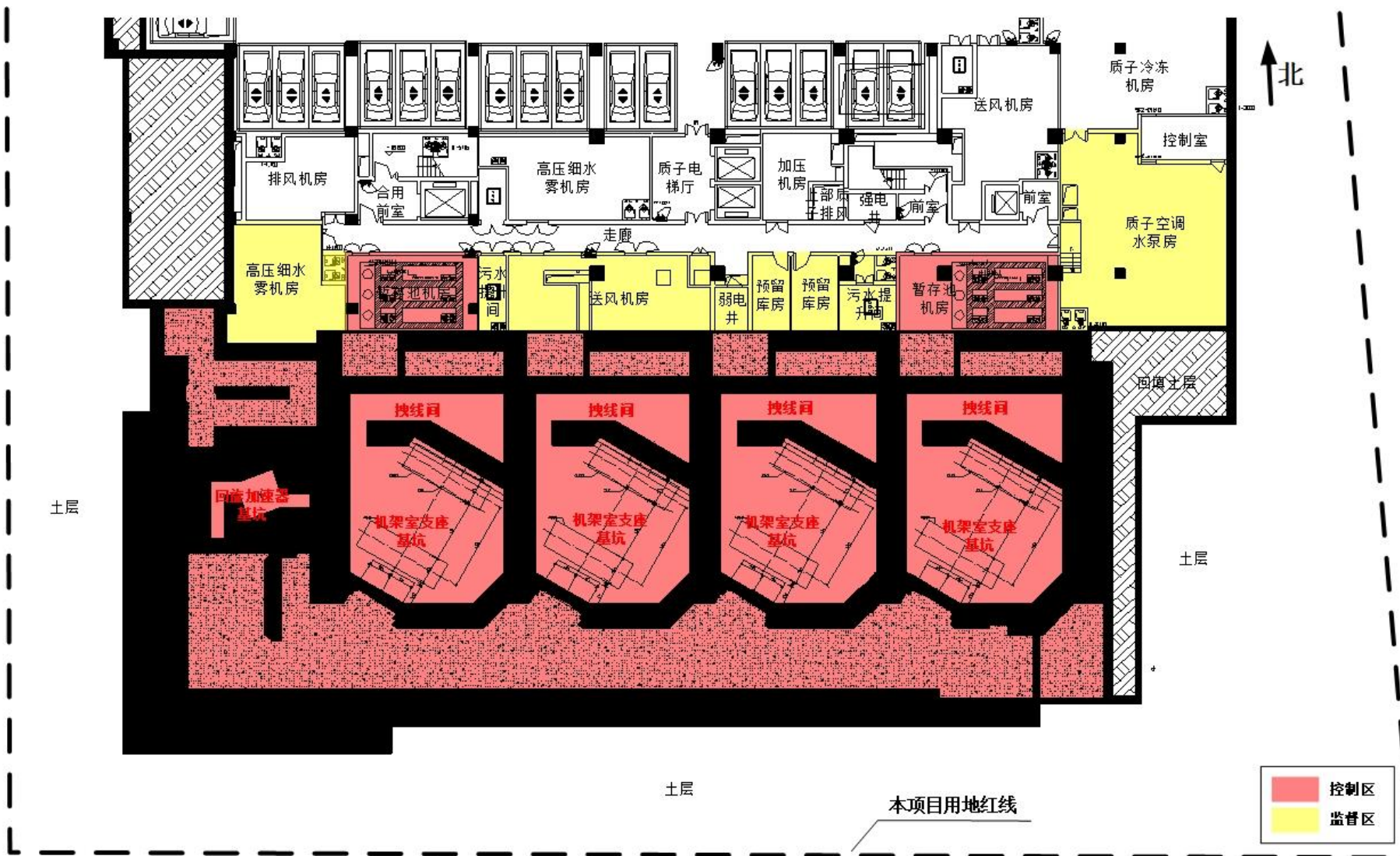
图 4.1.1.1-3 质子放射治疗系统负三层辐射工作场所分区图
